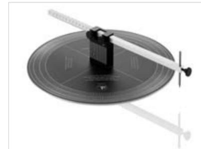
Multi Installation Gauge (für Radial- und Drehtonarme sowie Tonabnehmer, inkl. Stroboskopscheibe)
